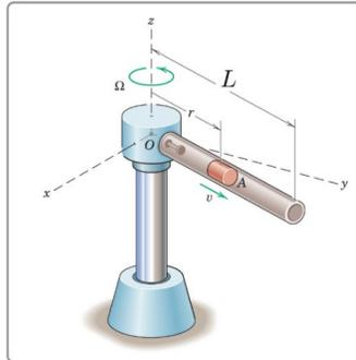
Det ihåliga röret med längden  $L$  roterar runt en vertikal axel genom  $O$  med en konstant vinkelhastighet  $\dot{\theta} = \omega$ . En cylinder med massa  $m$  glider friktionsfritt inuti röret. Cyindern börjar på ett avstånd  $r_0$  och har då farten  $v_0$  längs röret. Beräkna magnituden av den horisontella kraften  $P$  som verkar på cylindern precis när den lämnar röret. Svara i termer av  $L$ ,  $v_0$ ,  $m$ ,  $\omega$  och  $r_0$ .
