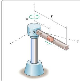
Det ihåliga röret med längden  $L$  roterar runt en vertikal axel genom  $O$  med en konstant vinkelhastighet  $\dot{\theta} = \omega$ . En cylinder med massa  $m$  glider friktionsfritt inuti röret. Cylindern börjar på ett avstånd  $r_0$  och har då farten  $v_0$  längs röret. Beräkna magnituden av den horisontella kraften  $P$  som verkar på cylindern precis när den lämnar röret. Svara i termer av  $L$ ,  $v_0$ ,  $m$ ,  $\omega$  och  $r_0$ .
