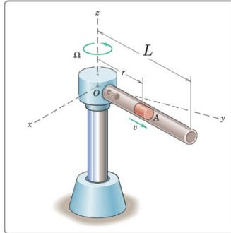
Det ihåliga röret med längden  $L$  roterar runt en vertikal axel genom  $O$  med en konstant vinkelhastighet  $\dot{\theta} = \omega$ . En cylinder med massa  $m$  glider friktionsfritt inuti röret. Cyldern börjar på ett avstånd  $r_0$  och har då farten  $v_0$  längs röret. Beräkna magnituden av den horisontella kraften  $P$  som verkar på cylindern precis när den lämnar röret. Svara i termer av  $L$ ,  $v_0$ ,  $m$ ,  $\omega$  och  $r_0$ .
