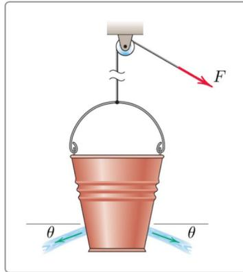
Hinken i figuren släpps från vila med initiala massan  $M$  (hink och vatten). Vattnet flödar ut genom hålen med farten  $v$ , totala massflödet  $\dot{m}$  (båda hålen tillsammans) och vinkeln  $\theta$  enligt figuren. Samtidigt drar en kraft  $F$  i snöret. Beräkna hinkens acceleration med positiv riktning uppåt i figuren.
